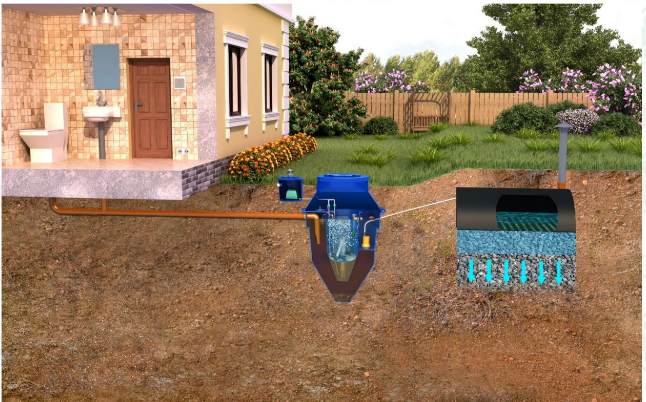
Рисунок 8. Монтаж ALFA PRO с отводом очищенных сточных вод в дренажный элемент
